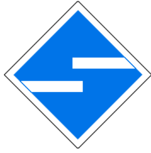
EL-3 KESİCİYİ (DİSJÖNKTÖRÜ) AÇ. PANTOGRAFI İNDİR.
