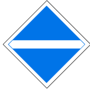
EL-4 BUNDAN SONRAKİ İŞARET LEVHASINDA KESİCİ AÇILACAK VE PANTOGRAF İNDİRİLECEK
